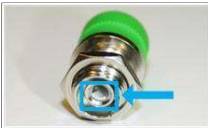
Рисунок 10– Пример неисправности — «излом металлического наконечника»
