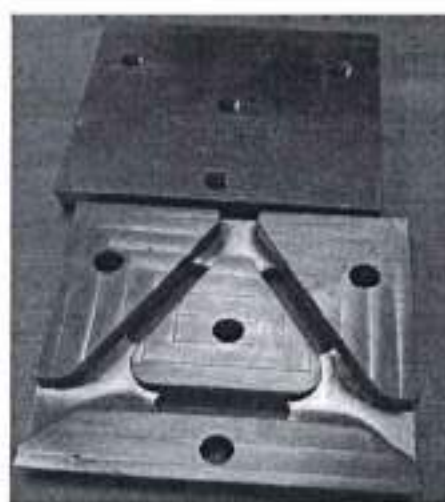
Рисунок 3 – Демонтаж крышки оснастки
