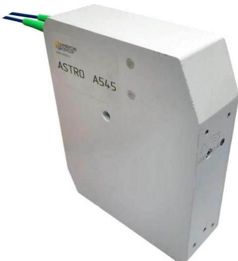
Датчик угла наклона ASTRO A545 измеряет углы наклона при изменении положения объекта, оснащен датчиками температурной компенсации и системой самокалибровки. Используется на строительных конструкциях, высотных зданиях, стволах шахт, платформах, шпилях зданий, радио и телевизионных вышках.
