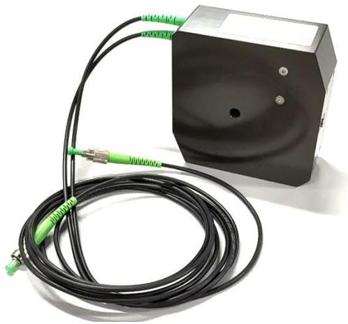
Принцип измерений углов наклона при изменении положения измеряемых объектов основан на изменении длины волны излучения под действием деформации брэгговской решетки, нанесенной на оптическое волокно, вызванной наклоном маятника под действием измеряемого углового положения.
